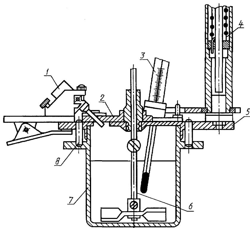
1 - зажигающая горелка; 2 - заслонка; 3 - термометр;
