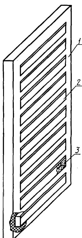
1 - корпус; 2 - емкости для горючей жидкости,
