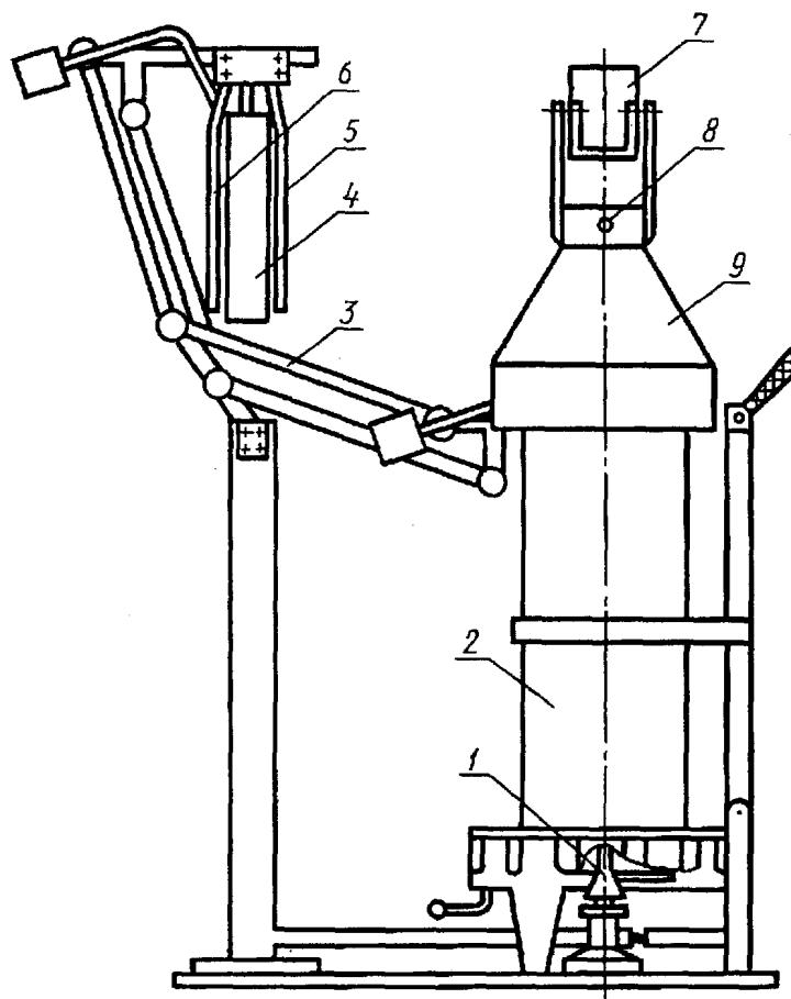
1 - горелка; 2 - реакционная камера;
