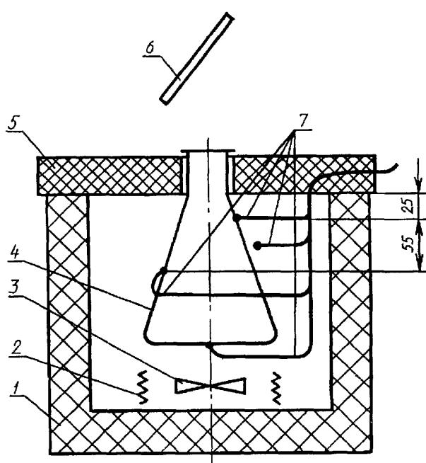
1 - корпус термостата; 2 - электрическая спираль нагревателя; 3 - крыльчатка вентилятора;
